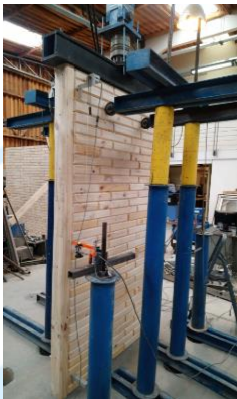
Figura N°1: Implementación de ensayo en compresión, según NCh 801.
