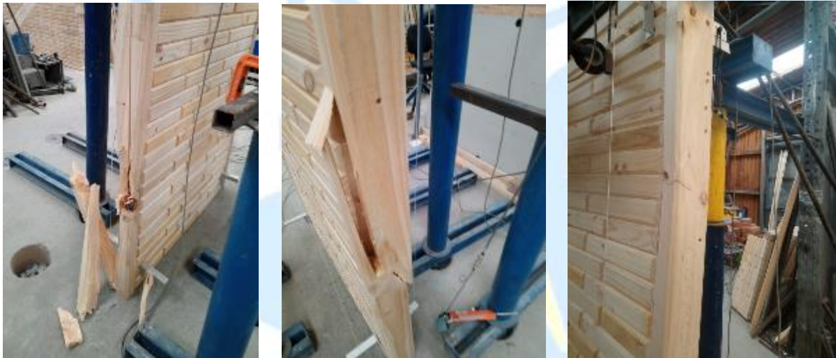
Figura N°3: Modos de falla por compresión para paneles cargados.
