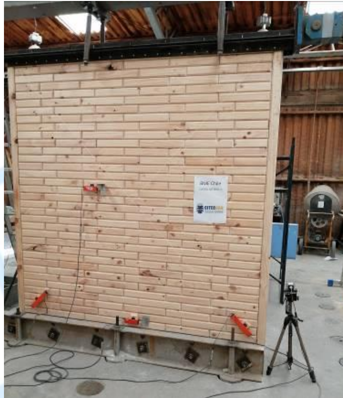
Figura N°1: Implementación de ensayo de carga horizontal, según NCh 802.
