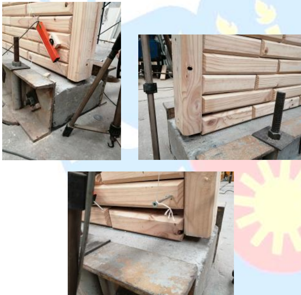
Figura N°4: Modos de falla por carga horizontal para paneles ensayados.
