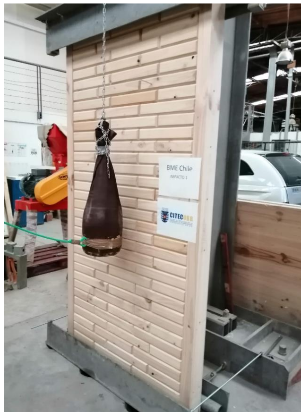
Figura N°1: Implementación de ensayos de impacto
