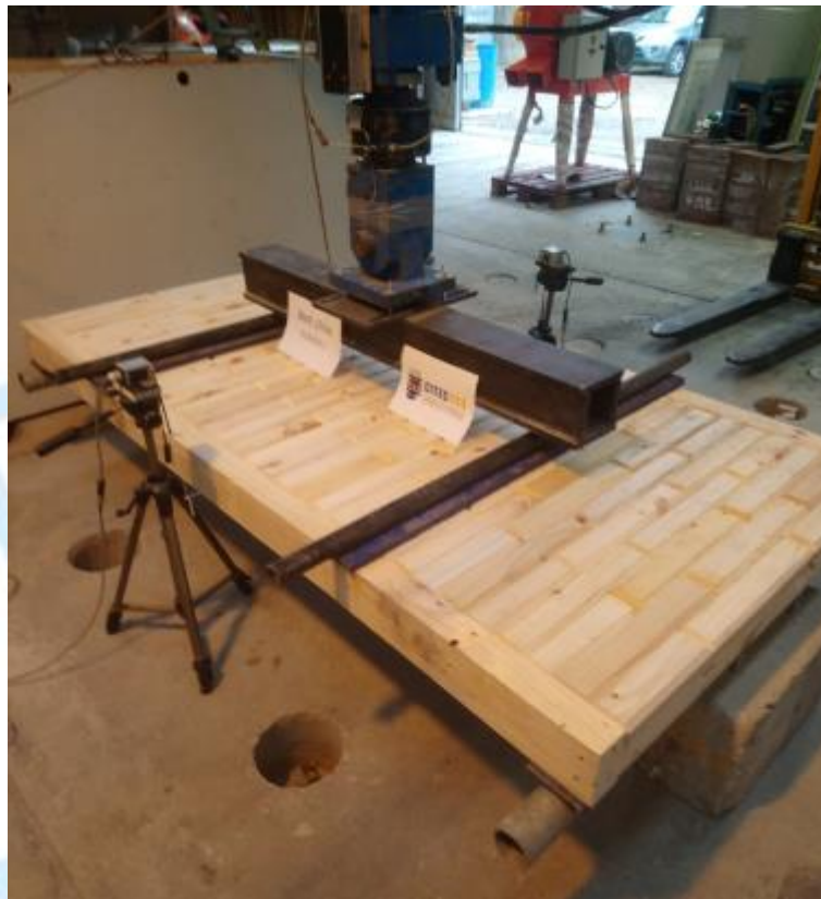
Figura N°1: Implementación de ensayo en flexión, según NCh 803.
